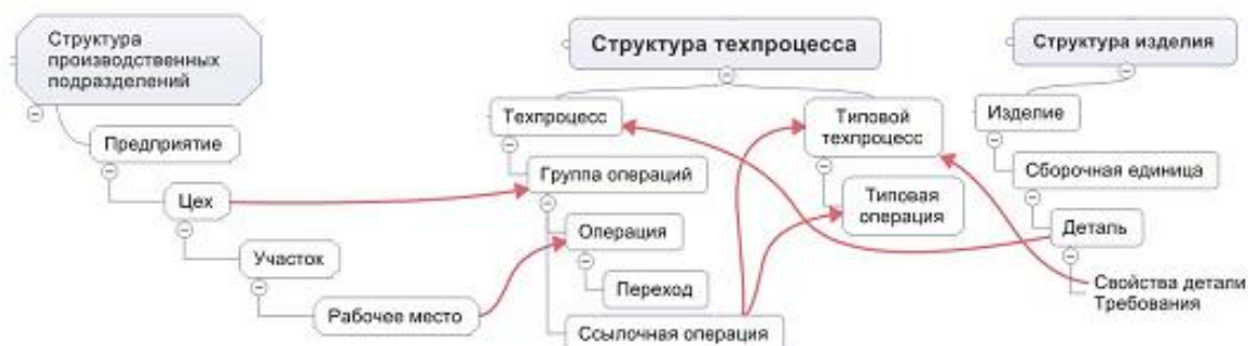
Рис. 21 Взаимосвязи элементов технологического процесса
