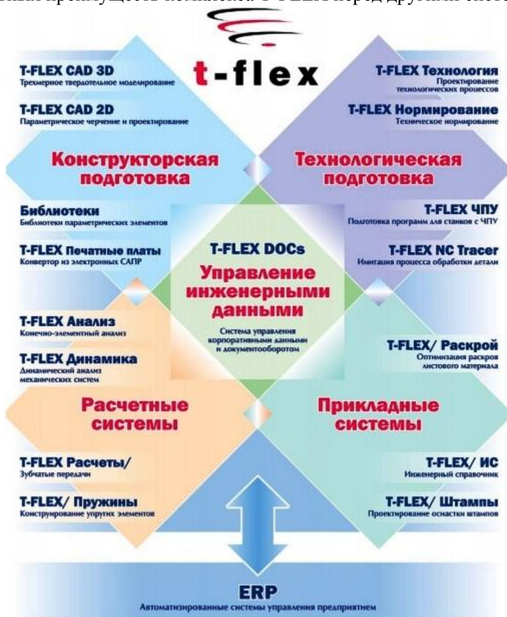
Рис. 2. Структура программного комплекса T-FLEX CAD/CAM/CAE/CAPP/PDM
