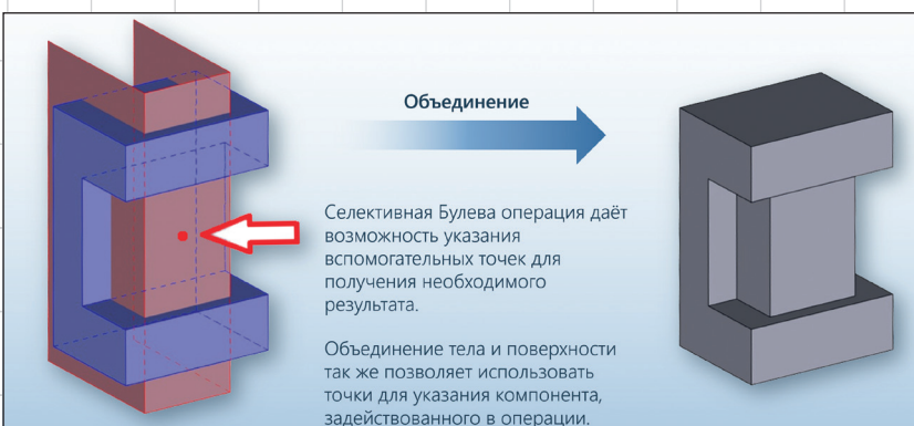
Рис. 31. Селективная булева операция (объединение) над твердым и поверхностным телами
