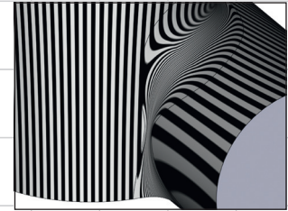
Рис. 16. Поддержка G2-гладкости на переменном и постоянном радиусах
