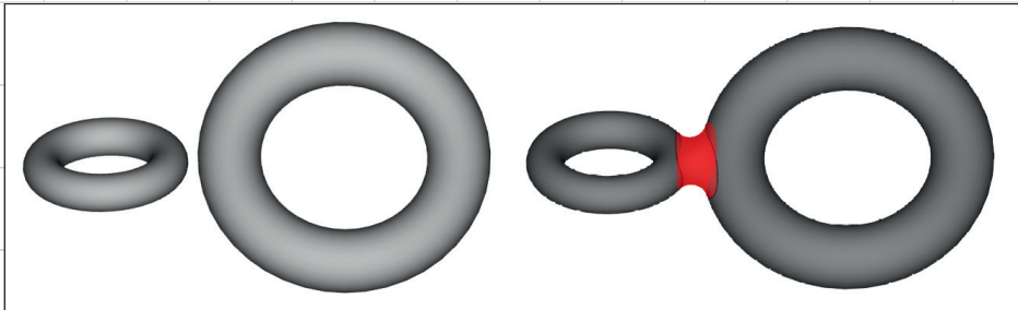
Рис. 23. Сглаживание граней, принадлежащих разным телам
