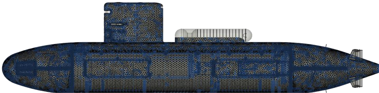
Рис. 1 - Диалог команды "Анализ сетки" и выделение КЭ, удовлетворяющие заданным критериям качества сетки
