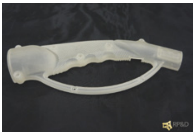
Рис. 8. Прототип корпуса из фотополимера для литья в силиконовые формы
