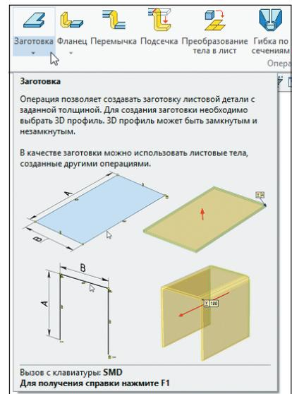
Рис. 2. Расширенная подсказка к операции *Заготовка*
