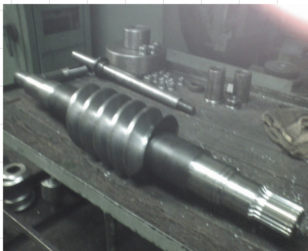
Рис. 12. Червяк с формой профиля ZT2 ГОСТ 18498-89, обработанный на токарном станке с ЧПУ 16А30Ф3 методом построчных проходов
