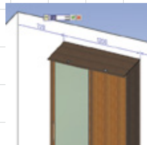
Рис. 7. Изменение положения моделей при помощи 3D-размеров мого редактирования (рис. 7), в результате чего изделие переместится в новое положение.
