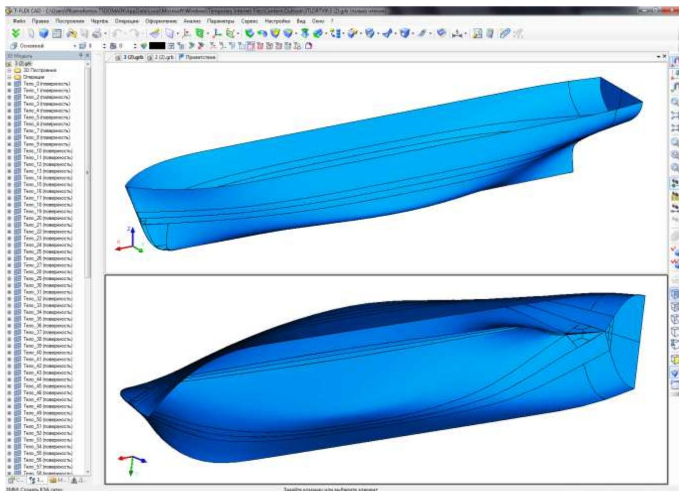
По этой модели уже средствами T-FLEX строятся проекции, производится расстановка размеров и прочих графических обозначений. Кроме того, средствами T-FLEX Анализ может быть произведён расчёт на прочность как всего корпуса, так и произвольного его фрагмента. Для решения этой задачи используются пластинчатые и объёмные конечные элементы, а также их комбинации.
