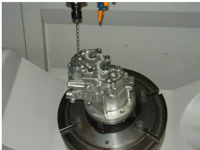
Рис. 7. Имитация 5D-сверления косоугольного канала
