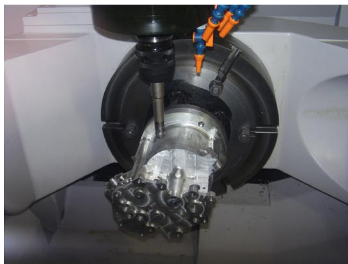
Рис. 5. Обработка цилиндрической поверхности корпусной детали (наклонная ось неподвижна, поворотный стол находится в непрерывном вращении)
