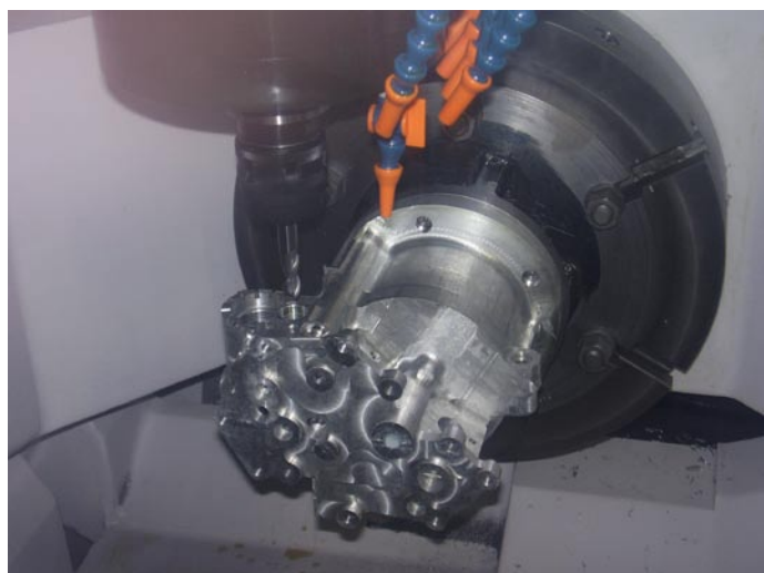
Рис. 4. Технологическая модель корпусной детали в процессе использования функции «3D Зонная обработка» (видно каркасное тело, ограничивающее зону обработки) из каналов
