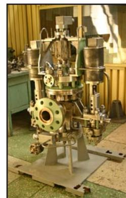
Импульсно-предохранительное устройство УФ 500024 используется для автоматического сброса давления рабочей среды из компенсатора давления в барботер при аварийном повышении давления в главном циркуляционном контуре реакторных установок АЭС
