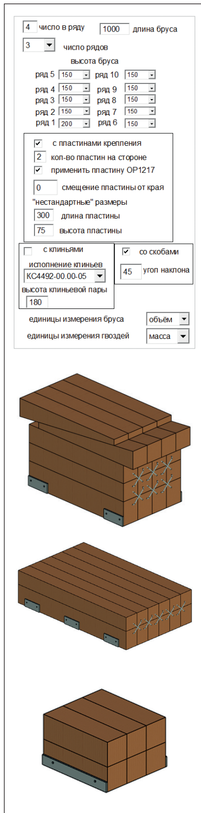
Рис. 2. Диалог параметров и варианты конфигурации модели брусовой подушки
