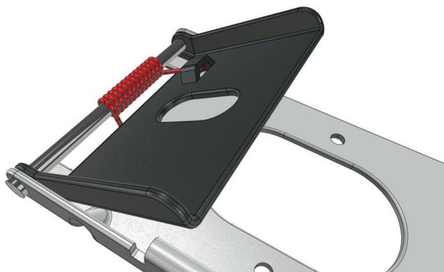
Рис. 13. Использование пружины кручения в сборке
