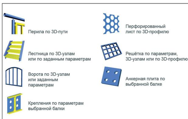
Различные генераторы конструкций системы TENADO METALL 3D
