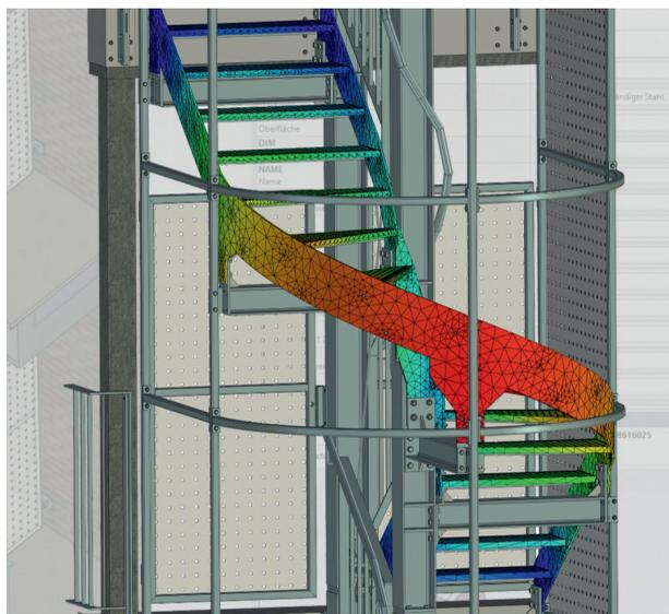
Расчет прочности конструкции лестницы в модуле TENADO STATIK
