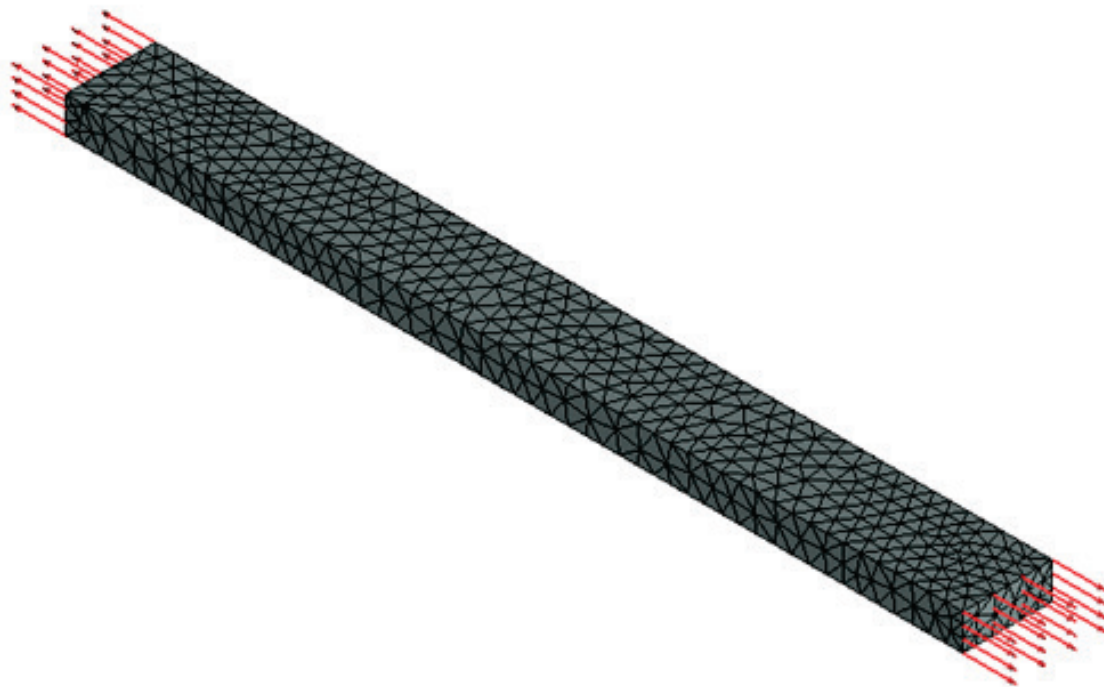
Рисунок 1.19-1 - Конечно-элементная модель при указанных нагрузке и закреплении.
