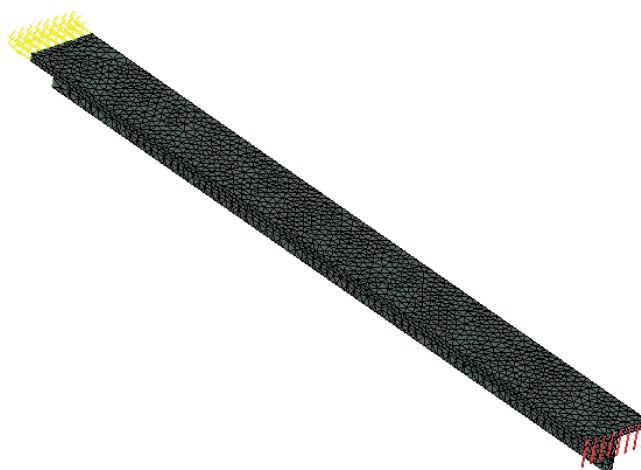
Рисунок 1.14-1 - Расчетная модель с нагрузками и закреплениями
