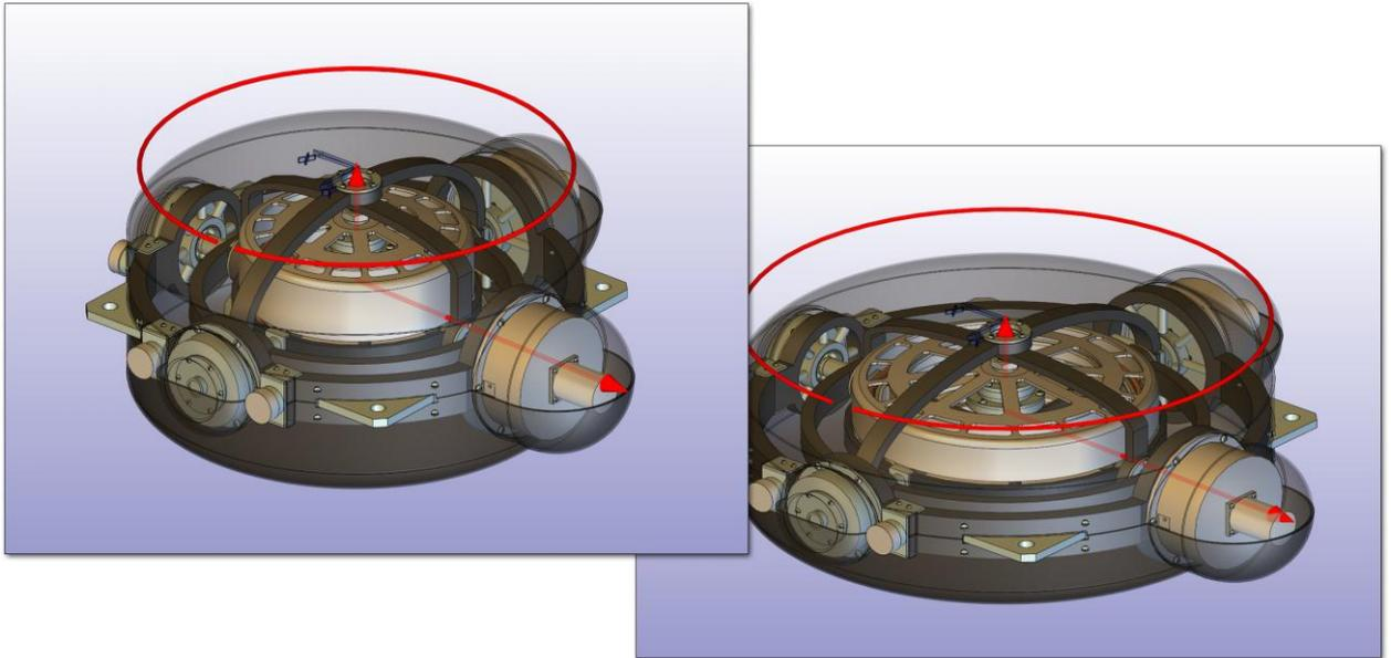
3D размеры, проставленные внутри документа детали, теперь можно “поднимать” в сборку. Они могут быть использованы не только просто для оформления, но и для того, чтобы управлять размерами модели посредством задания значения этих размеров.
