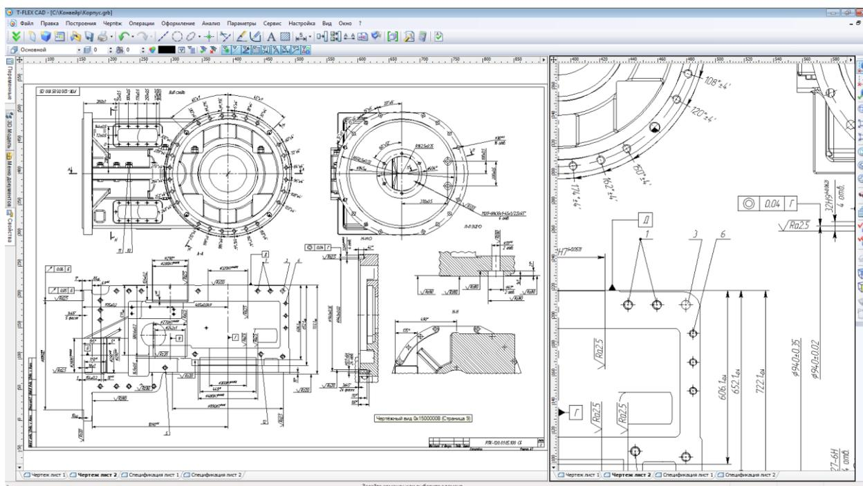
Реализована команда копирования свойств с существующих 2D элементов, линий изображения, штриховок, обозначения вида, допусков. В команде работы с обозначением вида появилась возможность формировать обозначение сечения/разреза по геометрии 2D пути. Таким образом, реализована возможность простановки сечения по дуге окружности, а также по сложной линии, включающей отрезки и дуги окружностей.
