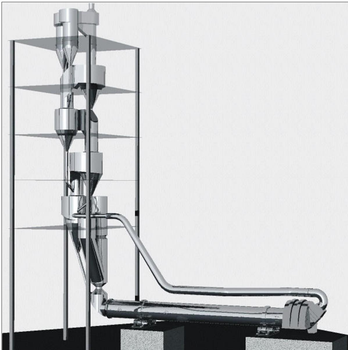
**Цементная вращающаяся печь с циклонным теплообменником и декарбонизатором. Спроектирована в системе T-FLEXCAD 3D.**
