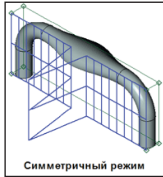
Три режима работы скульптурной деформации: односторонний, двухсторонний и симметричный
