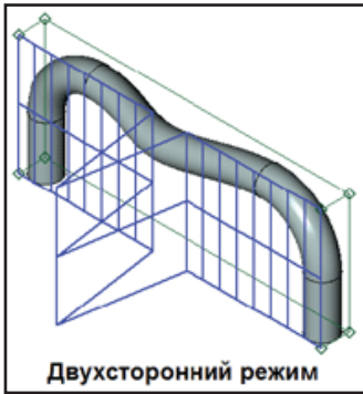
Три режима работы скульптурной деформации: односторонний, двухсторонний и симметричный
