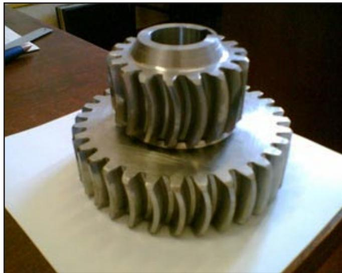
*Рис. 10. Арочные зубчатые колеса*
